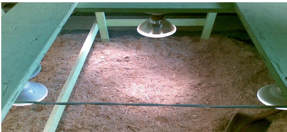
**Figura 1.** Secado de bagazo con lámpara incandescente.
