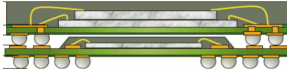
Figura 5 POP con el procesador y las memorias flash y RAM
