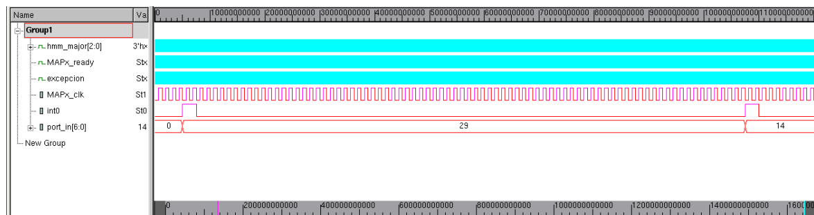
Figura 8.1: Resultado de la simulación del diseño original tras la síntesis; se puede ver como las señales superiores nunca salen del estado de alta impedancia.
