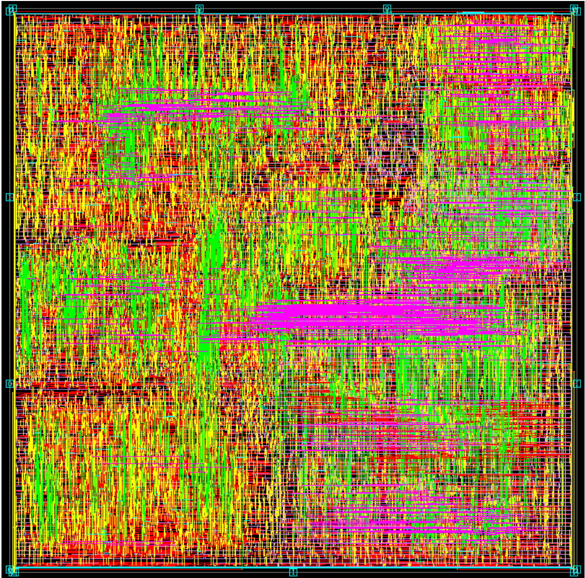
Figura 8.6: Trazado físico resultante de la implementación del módulo de modelos ocultos de Markov.
