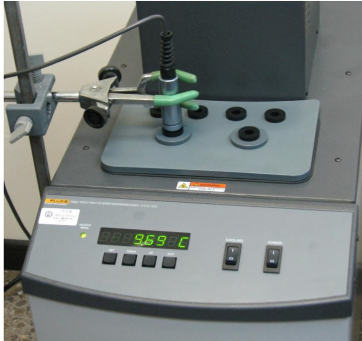
**Figura 5.1** Termómetro Fluke 5698 y baño de mantenimiento Fluke 7312
