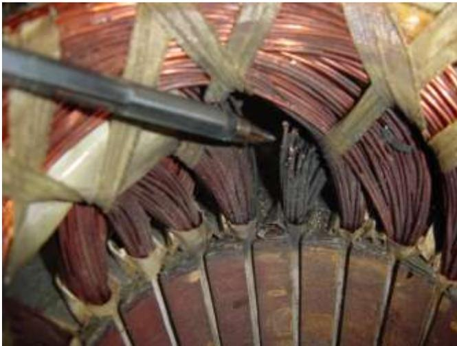
**Figura N°6. Fotografía Falla Corto Estator**
