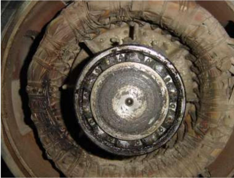
*Figura N° 7. Fotografía Falla por rodamiento*
