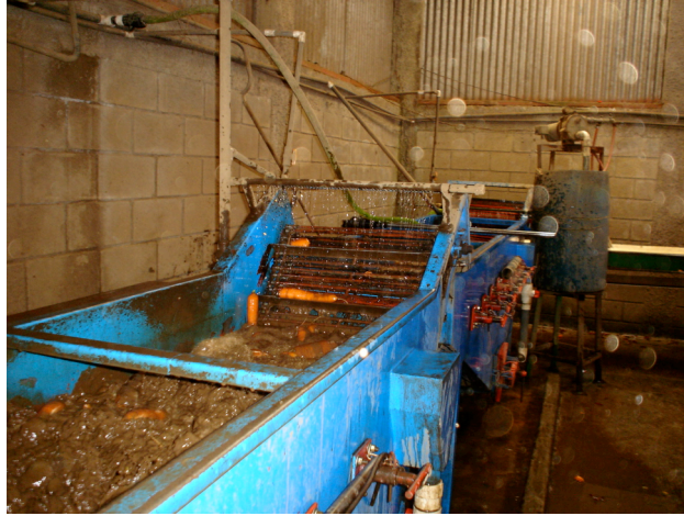
Figura 37. Recepción de raíces en tolva de agua para evitar daños en el producto ( Fuente C.Ramírez).
