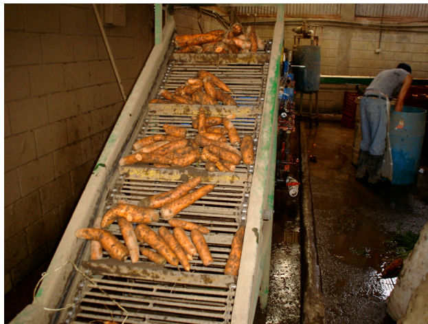
Figura 36. Recepción de las raíces y transporte hacia las tolvas por medio de la banda transportadora ( Fuente C.Ramírez).
