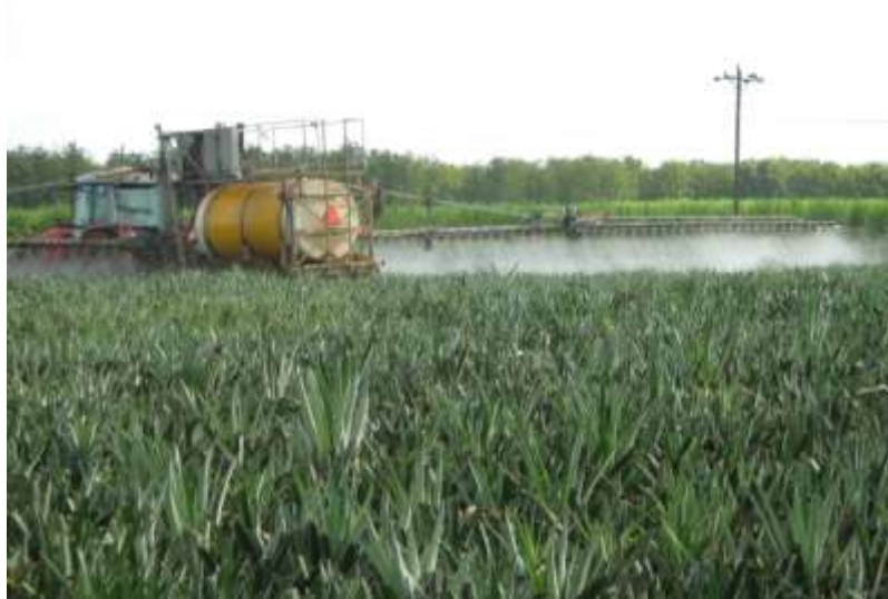
Figura 22. Equipo pulverizador, utilizado en las aplicaciones de fertilizante. Piña ( Ananas comosus ) híbrido Venecia Gold, Frutas Tropicales Venecia S.A. García, A. (2007).
