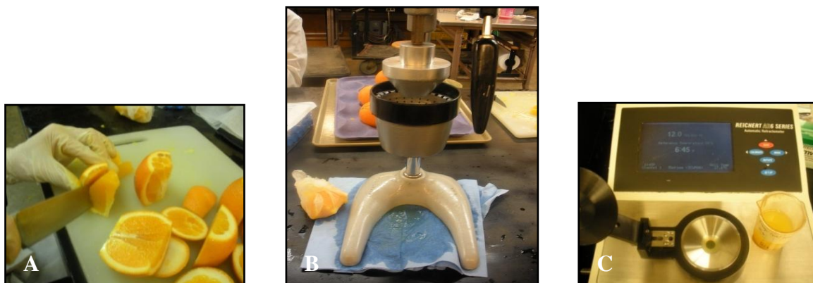
Figura 32. Procedimiento utilizado en la medición de sólidos solubles totales en naranja ( Citrus sinensis ), variedad Navel. Laboratorio Postcosecha de la Universidad de California en Davis, EEUU, 2009. (Según Villalobos, L. 2009).
