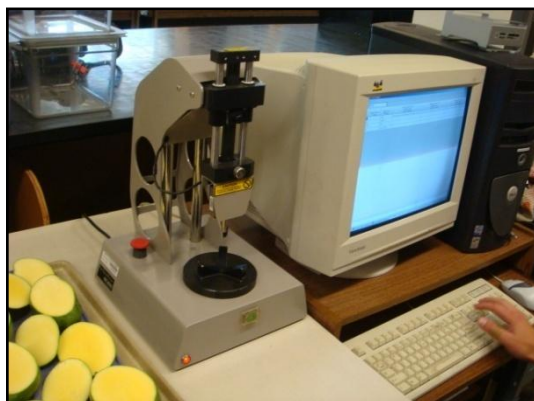
Figura 26. Penetrómetro Analyser GUSS GS-14. Laboratorio de Postcosecha de la Universidad de California en Davis, EEUU, 2008. (Según Villalobos, L. 2009).
