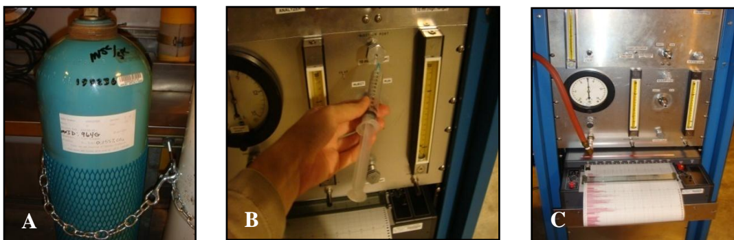
Figura 21. Metodología utilizada en la lectura de las muestras, para la cuantificación de las concentraciones de CO 2 en pera ( Pyrus communis ), variedad Bartlett. Laboratorio de Postcosecha de la Universidad de California en Davis, EEUU, 2009. (Según Villalobos, L. 2009).
