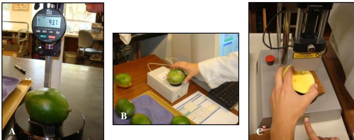
Figura 28. Instrumentos utilizados en la evaluación de firmeza en mango ( Mangifera indica ) variedades Tommy Atkins y Keitt. Laboratorio de Postcosecha de la Universidad de California en Davis, EEUU, 2008. A. Durómetro Rex. B. AFS Acoustic Firmness Sensor Aweta. C. Penetrómetro Analyser GUSS GS-14. (Según Villalobos, L. 2009).
