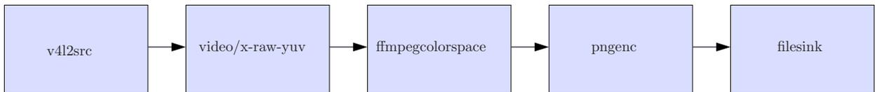
**Figura 3.3:** Secuencia de elementos de gstreamear para la captura, codificación y almacenamiento de una imagen png
