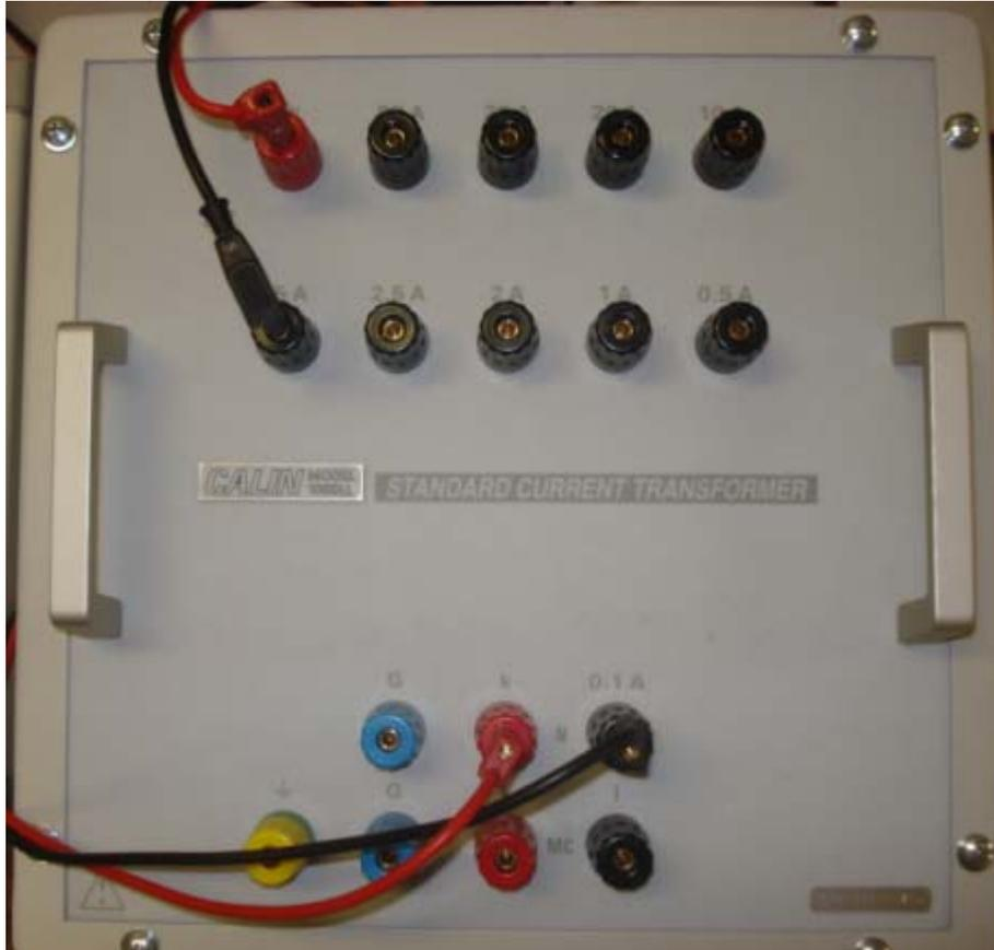
Figura 5. 14 Trasformador de corriente CALIN
