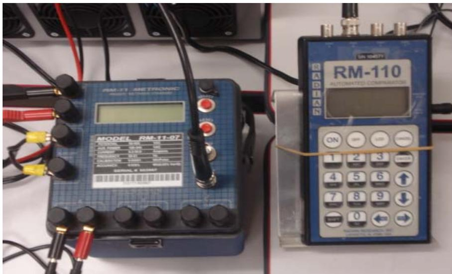
Figura 5. 16 Patrón monofásico de Potencia
