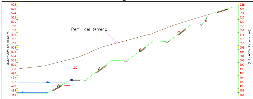
Figura 2. Sección original de taludes de corte.
