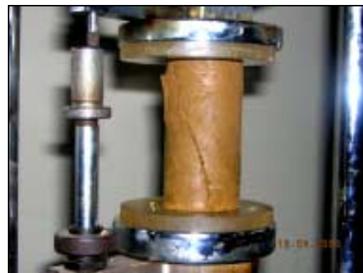
Figura 24. Prueba de compresión inconfinada. Pastilla remoldeada.
