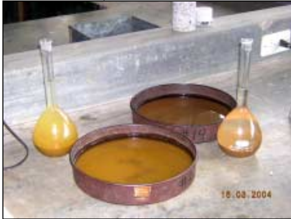
Figura 25. Determinación de la gravedad específica de sólidos
