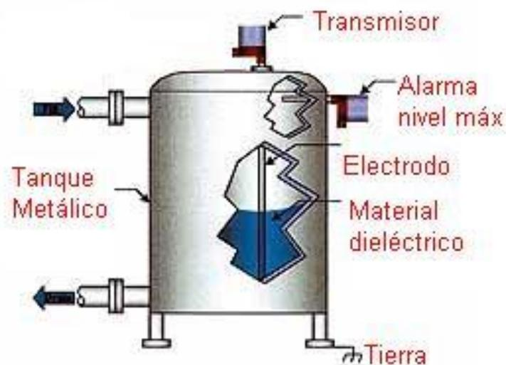
**Figura 3.4** Sistema de medición de nivel por capacitancia RF
