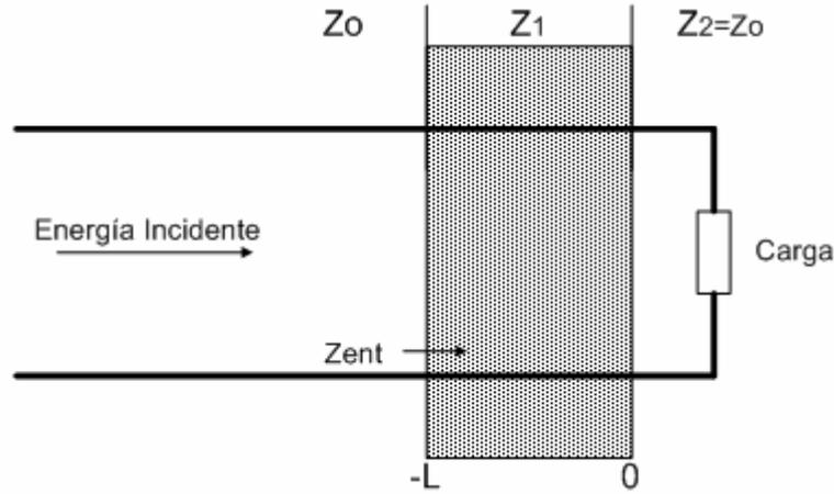
**Figura 3. 15** Línea de transmisión con diferentes medios dieléctricos
