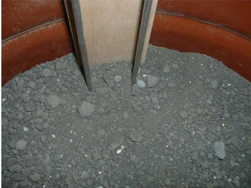
**Figura A.3. 3** Detalle del clinker acumulado entre los conductores de la línea de transmisión
