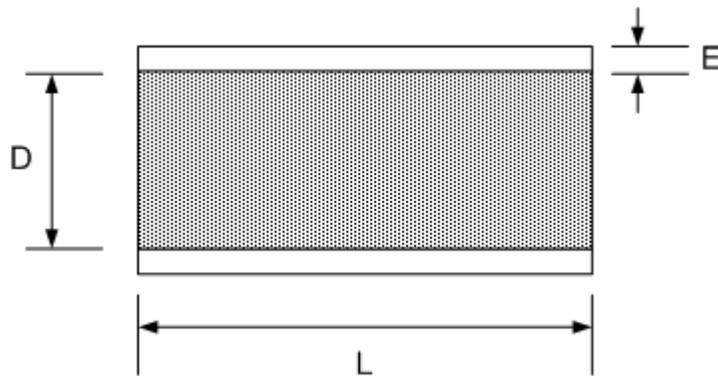
**Figura 3.10** Capacitor de placas paralelas (vista frontal)
