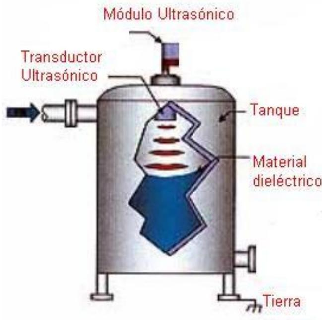
**Figura 3.7** Sistema de medición de nivel ultrasónico
