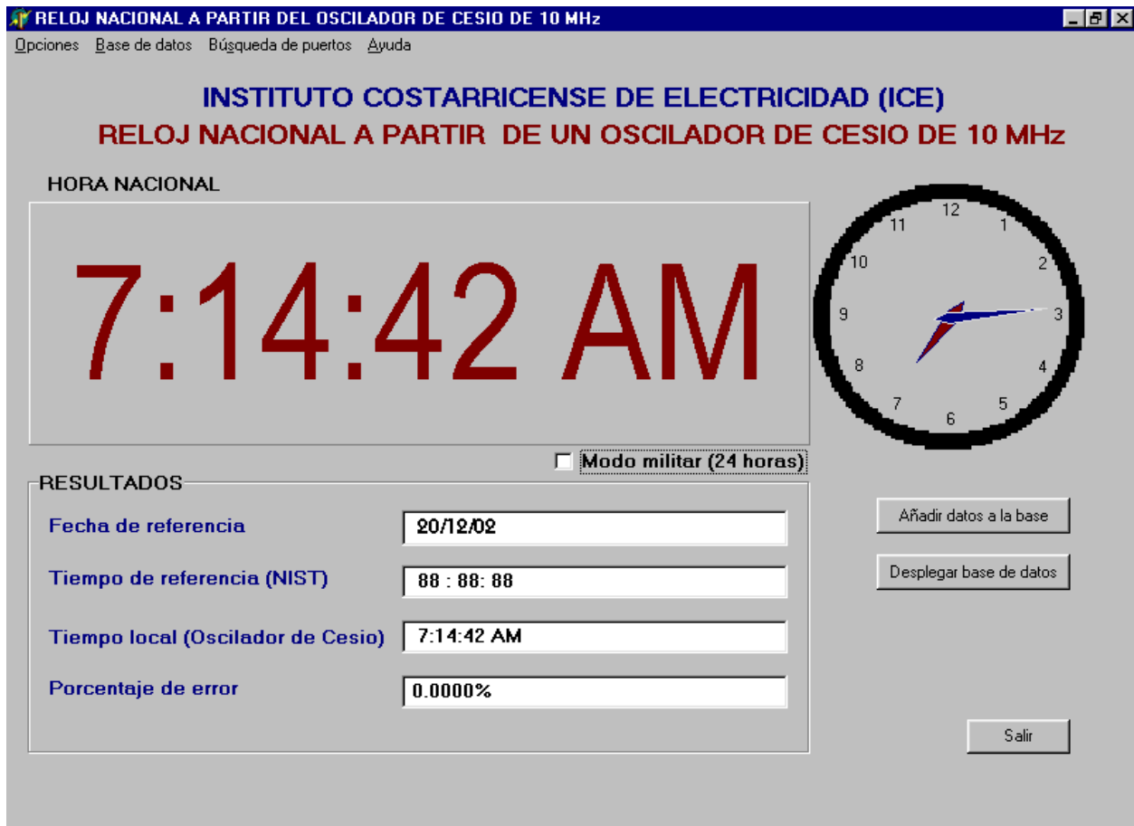
Figura A.4.1 Interfaz gráfica del reloj patrón a partir del oscilador de cesio de 10MHz.
