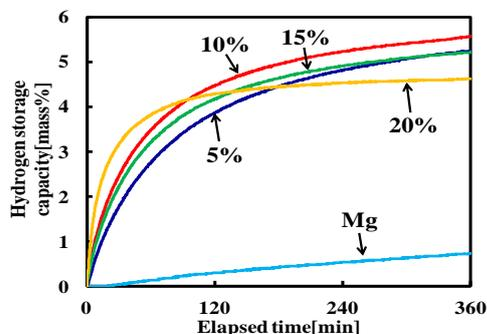
図2 Mg-CaNi<sub>3</sub>合金とMgの水素吸収量および吸収速度の比較(吸収温度473 K)
