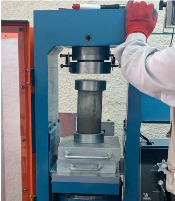
De igual manera, se aseguró de que los cilindros estuvieran adecuadamente curados. Se verificó también la correcta calibración de la máquina universal y la disponibilidad de un sistema operativo para controlar la velocidad de las cargas aplicadas. Los resultados obtenidos tras la ejecución de los ensayos se presentan en la Tabla 2.
