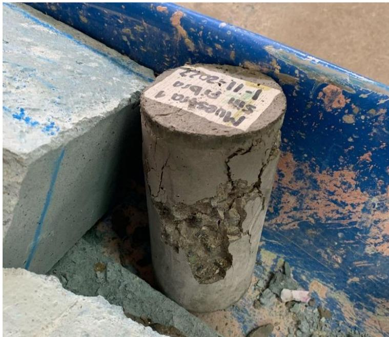
Anexo 11: Ensayos de probetas cilíndricas con incorporación de fibra
