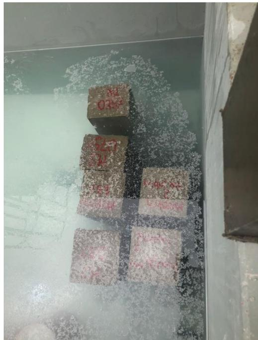
Anexo 6: Secado de probetas
