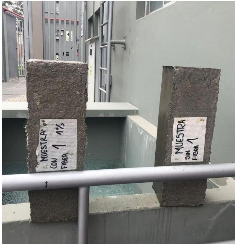
Anexo 7: Ensayo de flexión de vigas normalizadas.
