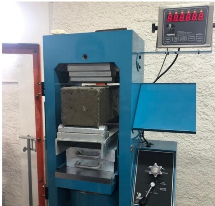
Previo a la realización de los análisis de laboratorio, se aseguró que las viguetas cumplieran con el adecuado proceso de curado. Asimismo, se verificó que la máquina universal estuviera debidamente calibrada y equipada con un sistema operativo que permitiera un control preciso de la velocidad de la carga aplicada. Los resultados obtenidos tras la ejecución de los ensayos se presentan en la Tabla 1.
