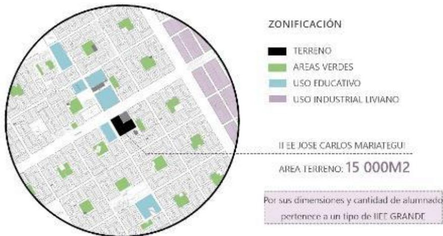
El terreno por sus dimensiones es de tipo III, según la normativa cumple ciertas condiciones con respecto a futuras ampliaciones dedicando el 20% del área libre, el cual es el 60% del área total del terreno. Además, se permite hasta cuatro pisos de altura como máximo con respecto al nivel secundaria (tabla 4).
