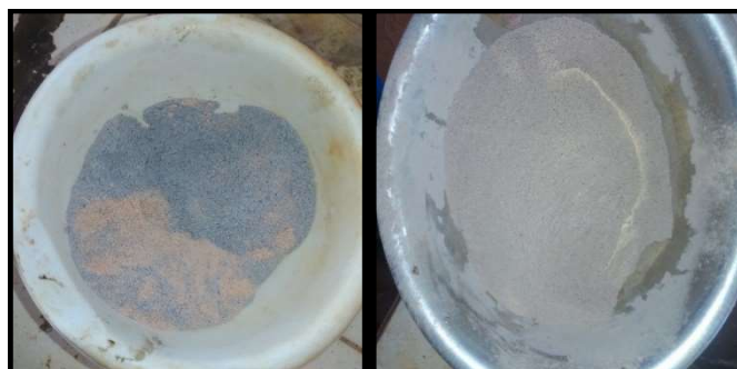
Figure Erreur ! Il n'y a pas de texte répondant à ce style dans ce document..15: Obtention de l'homogénéité de l'aluminosilicate
