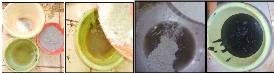
Figure Erreur ! Il n'y a pas de texte répondant à ce style dans ce document..14: Etape de fabrication de silicate de soude
