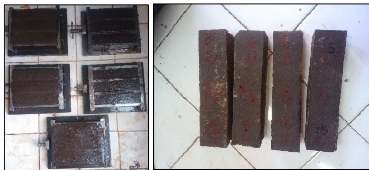
Figure Erreur ! Il n'y a pas de texte répondant à ce style dans ce document..18: Moulage et démoulage
