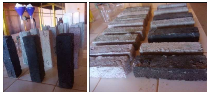
Figure Erreur ! Il n'y a pas de texte répondant à ce style dans ce document..19: Séchage des éprouvettes
