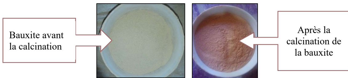
Figure Erreur ! Il n'y a pas de texte répondant à ce style dans ce document..10 : Obtention bauxite calcinée
