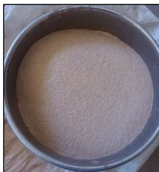
Figure Erreur ! Il n'y a pas de texte répondant à ce style dans ce document..8 : Bauxite broyée
