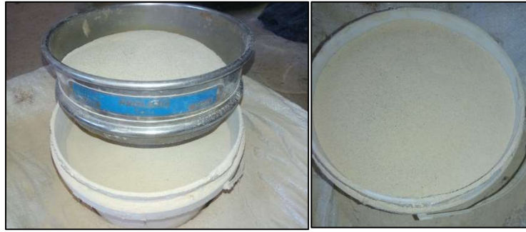
Figure Erreur ! Il n'y a pas de texte répondant à ce style dans ce document..9: Tamisage de la bauxite
