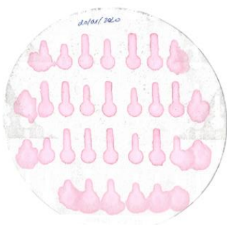
Hình 6. Thiết bị μPADs được chế tạo ở nhiệt độ 150°C trong 15 phút bằng máy khuấy từ
