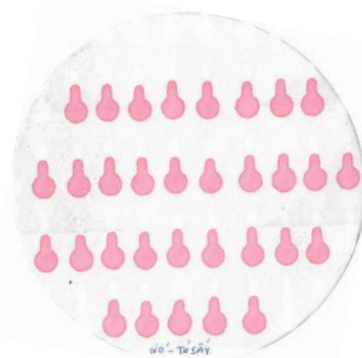
Hình 7. Thiết bị μPADs được chế tạo ở nhiệt độ 150°C trong 20 phút trong tủ sấy
