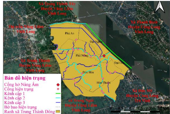
Hình 2. Bản đồ hệ thống thủy lợi KVNC
