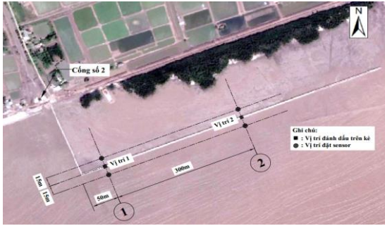
Hình 3. Sơ họa vị trí lắp đặt sensor trong hai đợt đo sóng
