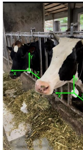
Hình 8. Thiết bị cố định trên cổ bò và ba trục tọa độ chỉ thị của cảm biến gia tốc cho 2 bò có mã 1 và 2
