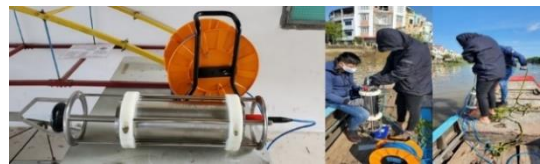
Hình 5: Đo lưu tốc dòng chảy
