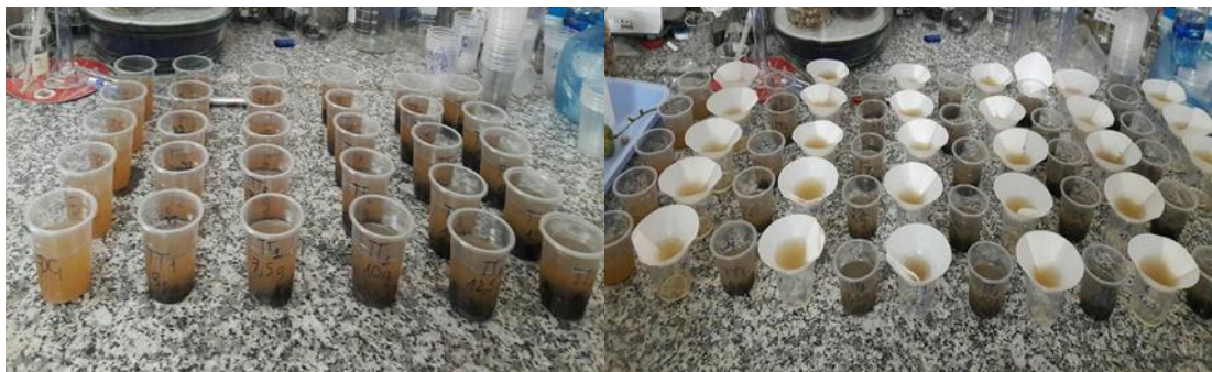
Hình 6. Bố trí thí nghiệm hấp phụ lân trong nước thải biogas bằng đất phèn tiềm tàng nung không có oxy
