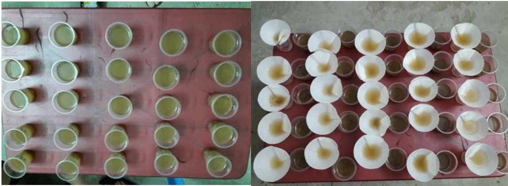
Hình 7. Bố trí thí nghiệm hấp phụ lần trong nước thải biogas bằng ĐPTT nung trong điều kiện có oxy
