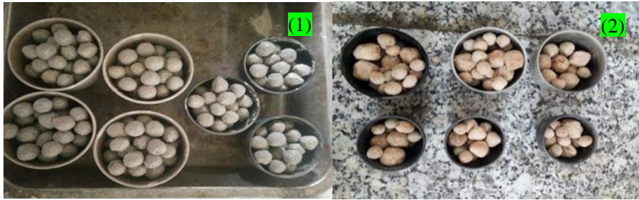
Hình 3. ĐPTT chưa nung (1) và đã nung trong điều kiện có oxy (2)
