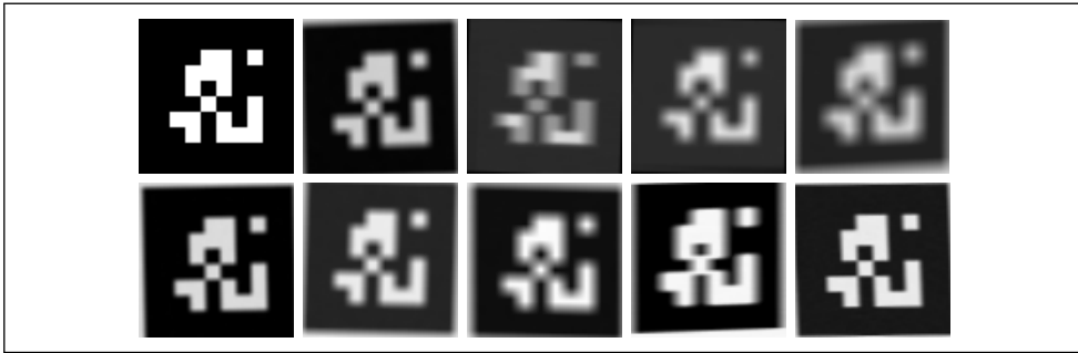
Figura 4.3: Transformaciones aleatorias generadas para un marcador. El marcador original (arriba-izquierda), el resto son las transformaciones sintéticas generadas.
