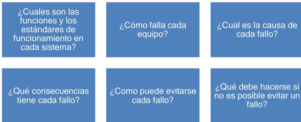
**Figura 13. Principales elementos de análisis para un mantenimiento centrado en la fiabilidad**
