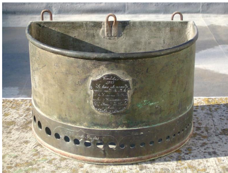
Figura 7. Arca de agua, o aforador, conservada en la Empresa Municipal de Aguas de Córdoba. Año de 1869 (Fuente: Pizarro, 2014).
