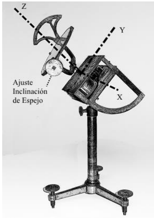
Fig. 43 Heliostato polar o de Fahrenheit
