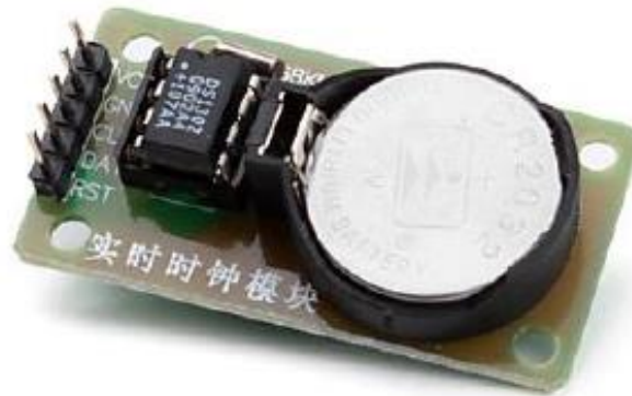
Fig. 80 RTC DS1302 con oscilador y pila.
