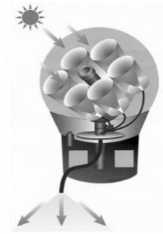
Fig. 13 Conductos de Fibra Óptica
