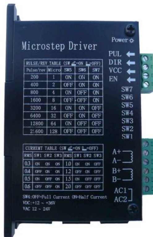
Fig. 86 Driver para motor paso a paso.
