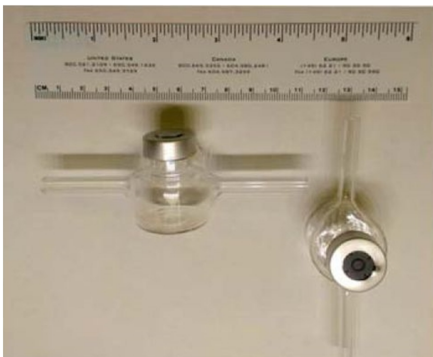
Figura M.1. Bote específico para medir óxido nítrico. Adaptado de (Sparacino-Watkins et al., 2014).
