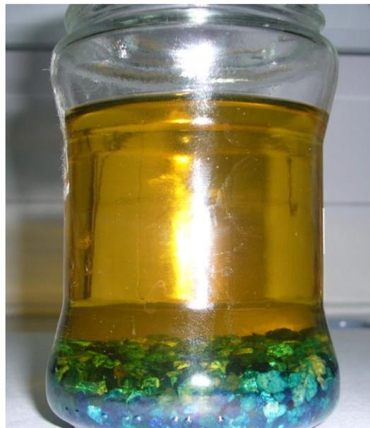
**Figura 3.4.** Ecodiesel obtenido a partir de aceite usado (muestra 8 en la Tabla 3.3) según el procedimiento indicado en la Tabla 3.4, en contacto con un adsorbente.
