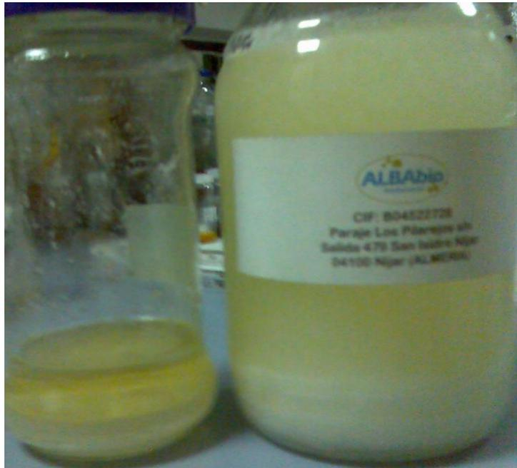
**Figura 3.3.** Ecodiesel obtenido a partir de grasa animal (muestra 4 en la Tabla 3.3) según el procedimiento indicado en la Tabla 3.4, y biodiesel convencional de Albabio, a temperatura ambiente de 2°C.
