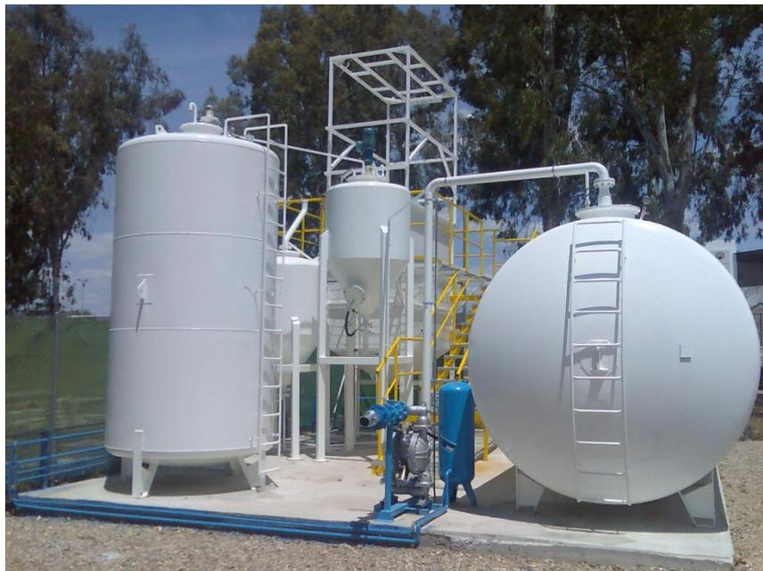
**Figura 2.3.** Instalaciones de la Planta Piloto de Seneca Green Catalyst, SL. El reactor discontinuo de tanque agitado (300 rpm) de 1500 litros, Dotado de un tanque auxiliar para la decantación de los residuos, y posterior limpieza por adsorbentes.
