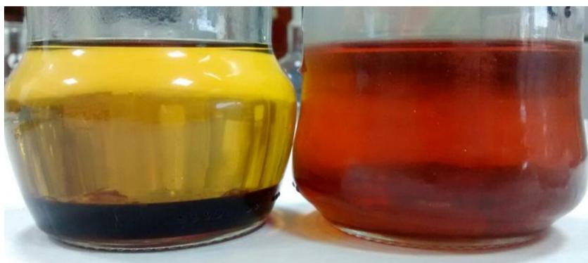
**Figura 3.12.** Aspecto visual del aceite de partida y del producto obtenido tras la reacción test, efectuada en las condiciones indicadas en la Tabla 3.33, pero empleando una relación 100/8/2, de aceite, metanol y metóxido sódico.
