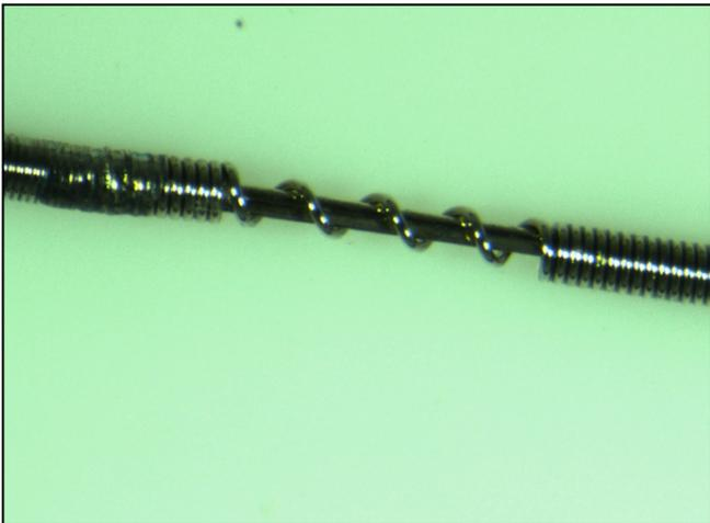
**Figura 38. Daño leve en guías no polimérica**
