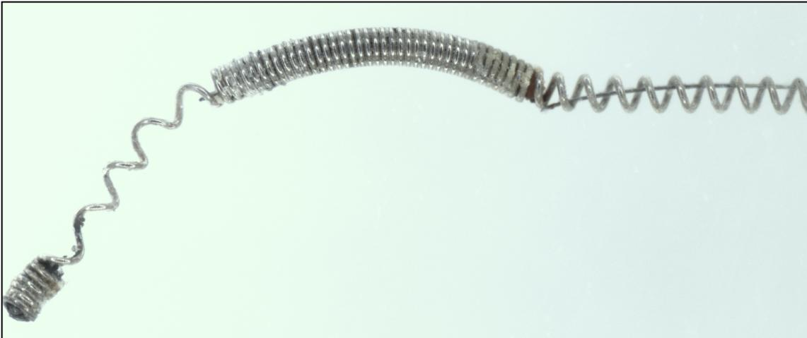
**Figura 44. Daño severo en guía no polimérica**
