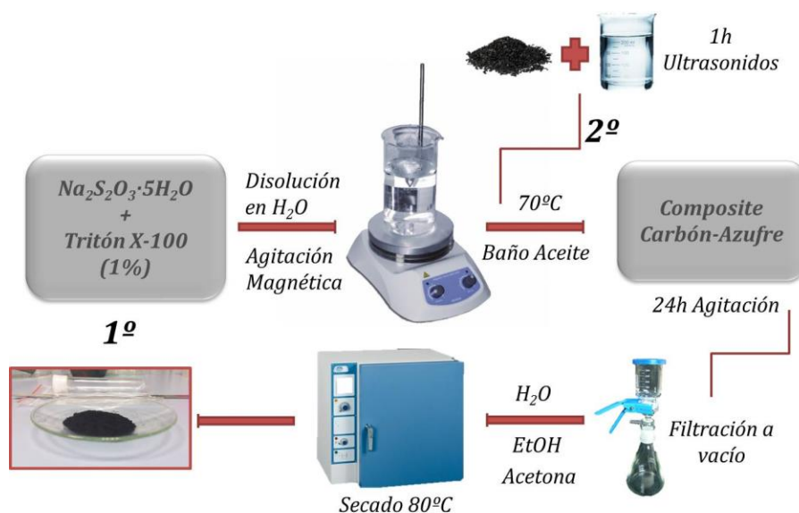
Figura 3.5 Diagrama de flujo general para la síntesis de composite.
