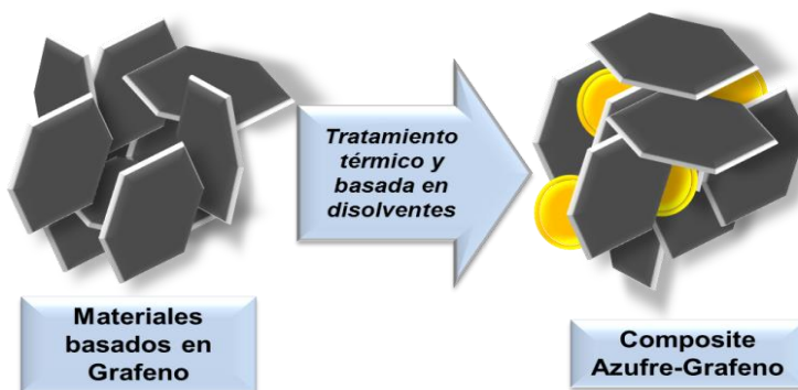
Figura 2.20. Esquema de síntesis de composites azufre-grafeno.
