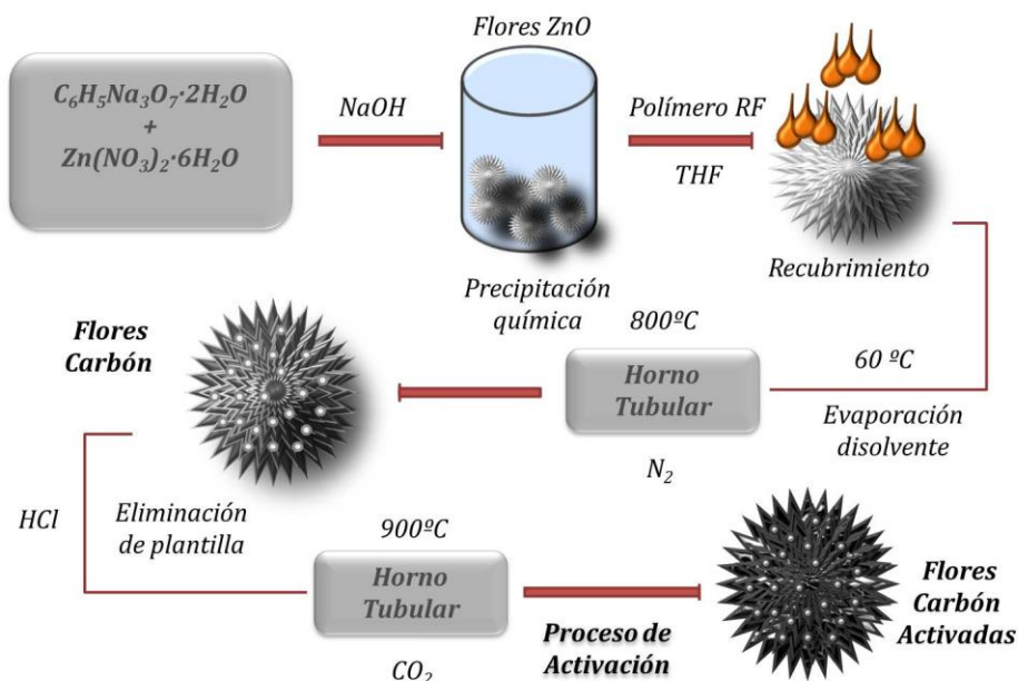
Figura 3.4 Diagrama de flujo de la síntesis del carbón (morfología en forma de flores) sin y con activación
