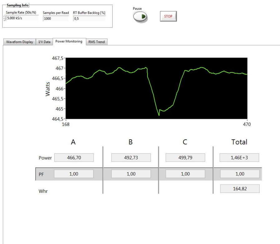
Figura C11. Test para la medida de parámetros de energía eléctrica.
