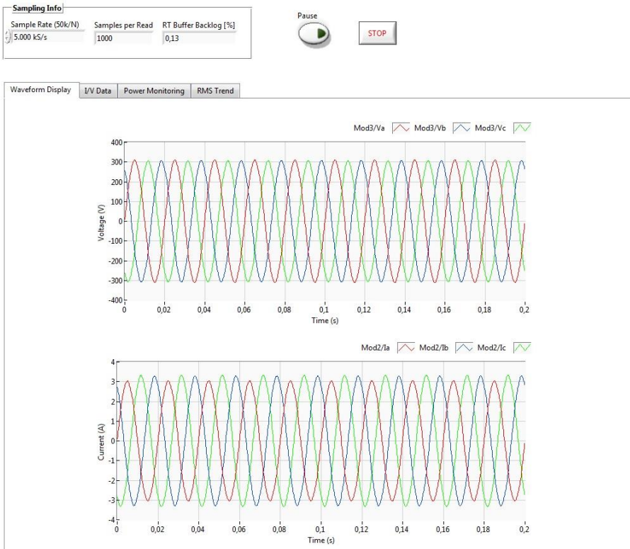
Figura C10. Test para la medida de parámetros de energía eléctrica.
