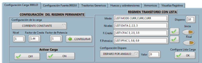
Figura 5-6. Control de la carga.
