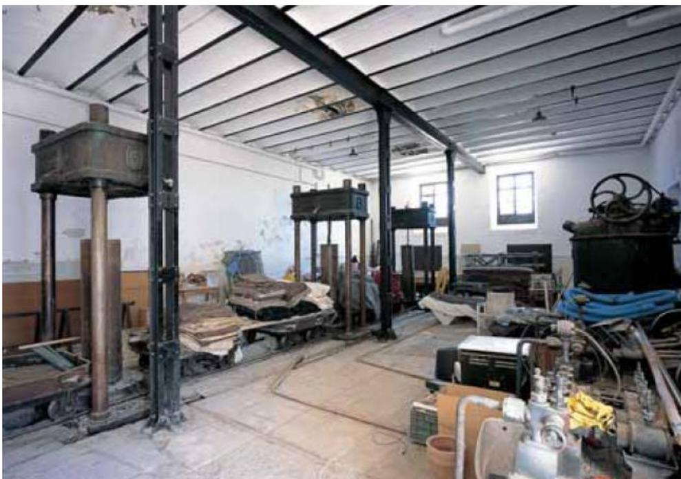
fig. 75.- Almazara con prensas hidráulicas y formador de cargos Hacienda Los Dávalos de Lucena (Córdoba). Fuente: Cortijos, haciendas y Lagares de Córdoba, Tomo I, pág. 171. Consejería de Obras Públicas y Transportes de Junta de Andalucía.
