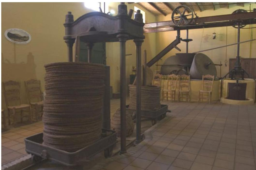
fig. 76.- Almazara con prensas hidráulicas y formador de cargos. Museo de Los Albardinales de Tabernas (Almería). Fuente: [http:// www. Olearum.es](http://www.Olearum.es)
