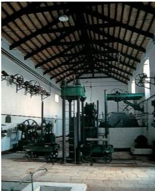
fig. 77.- Almazara con prensas hidráulicas y formador de cargos Cortijo la Higuera de Aguilar de la Frontera (Córdoba).
