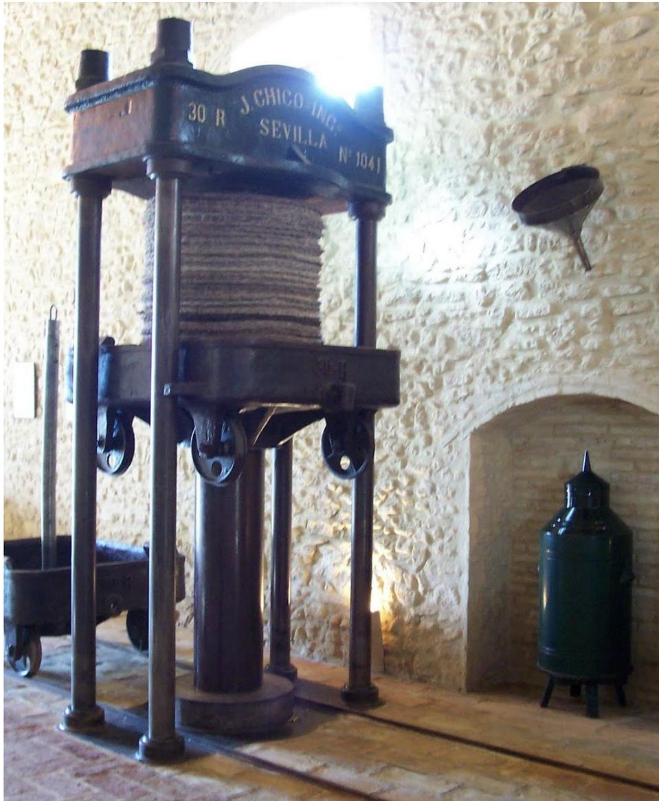
fig. 70.-Prensa hidráulica sistema marqués de Cabra. Museo del Aceite Juan Colín de Montilla (Córdoba).
