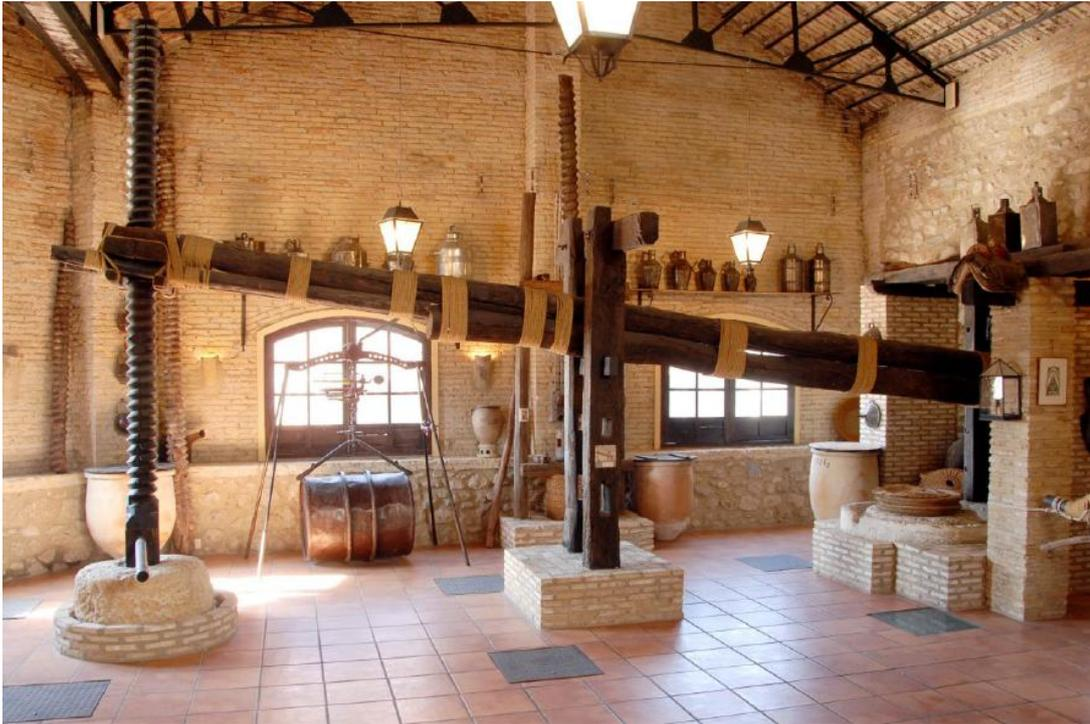
fig. 61.- Prensa de Viga del Siglo XVII, de 12x5 metros, con todas piezas y 2.000 kilos de peso. Museo en Cabra (Córdoba).
