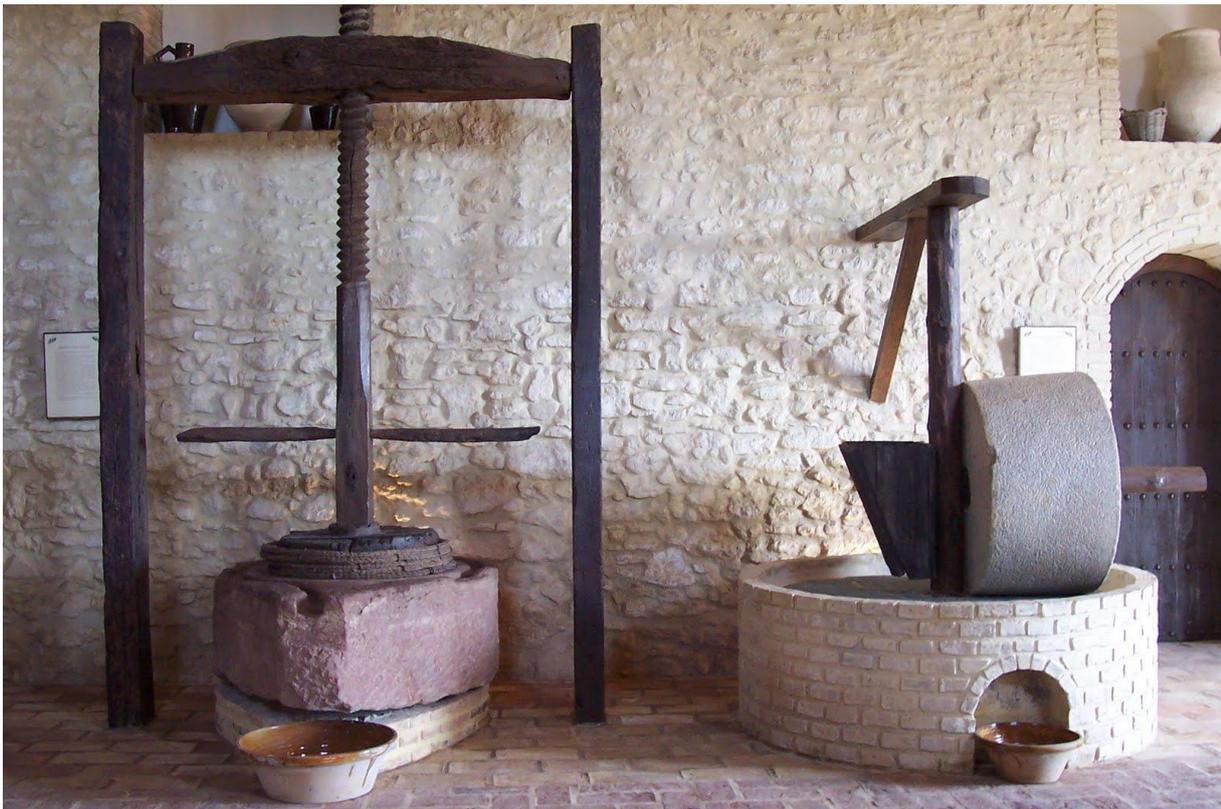
fig. 52.- Prensa de capilla y alfarje de muela cilíndrica, Museo del Aceite Juan Colín de Montilla (Córdoba).
