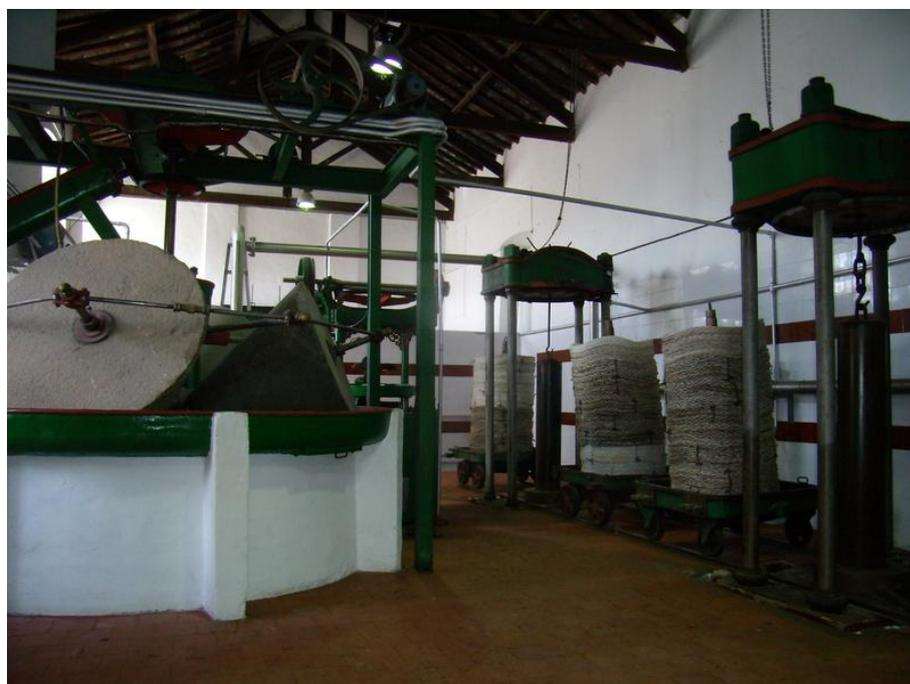
fig. 78.-Almazara con prensas hidráulicas y formador de cargos. Hacienda Peñillas. Baena (Córdoba) Foto: P. Lorenzo.
