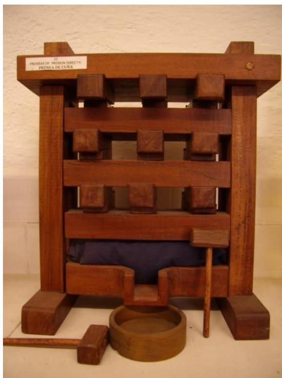
fig. 38.-Maqueta Prensa de cuñas. Museo de maquetas en miniaturas de molinos de Aceite en Mengibar.
