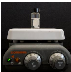
Figura 10. Fotografía del sistema de extracción original. Reproducido de la Ref. 8.
