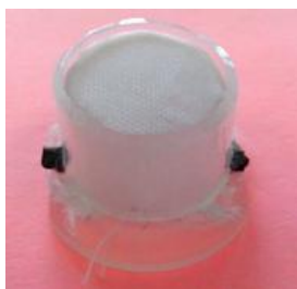
Figura 12. Fotografía de la unidad de extracción con fabric phase agitada.
