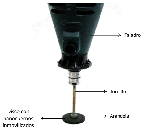
Figura 8. Sistema de extracción propuesto de microextracción en fase sólida basado en nanocuernos de carbono oxidados inmovilizados sobre disco.
