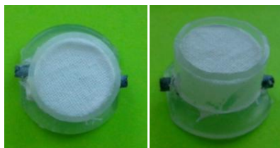
Figura 8. Sistema de extracción con fabric phase agitada.
