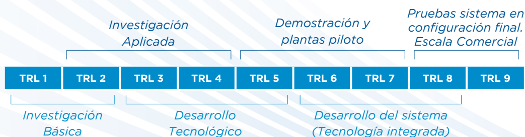
Figura 7. Relación de la escala TRL con las principales actividades del proceso de innovación.
