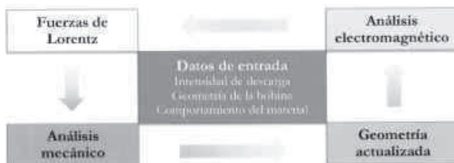
Figura 24. Esquema del modelo de acoplamiento débil
