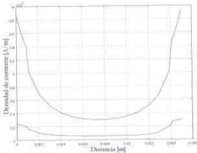
Figura 57. Distribuciones de corriente en la cara interna del concentrador
