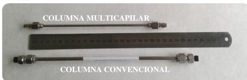
Figura 5. Foto comparativa de las dimensiones de una columna multicapilar y de una convencional.
