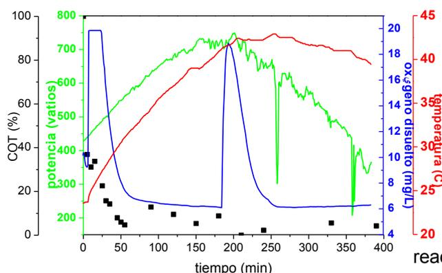
Los resultados a escala de laboratorio fueron perfectamente extrapolables a mayor escala. Además, como se puede comprobar en la Figura de la izquierda, el compuesto pudo destruirse totalmente mediante fotocátalisis. Ensayos de toxicidad (*V. fischeri*) pusieron de manifiesto la formación de algunos intermedios más tóxicos que la propia 3-cloropiridina a medida que transcurría la reacción.
