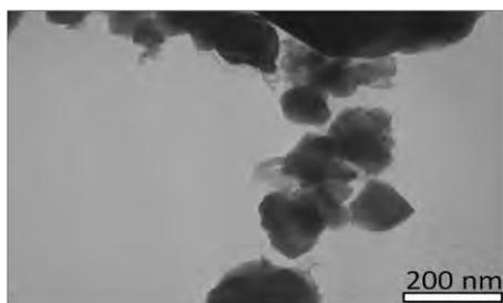
Figura 1. Imagen de MET de  $\text{Li}_{1.2}\text{Ti}_{1.8}\text{Fe}_{0.2}(\text{PO}_4)_3/\text{C}$
