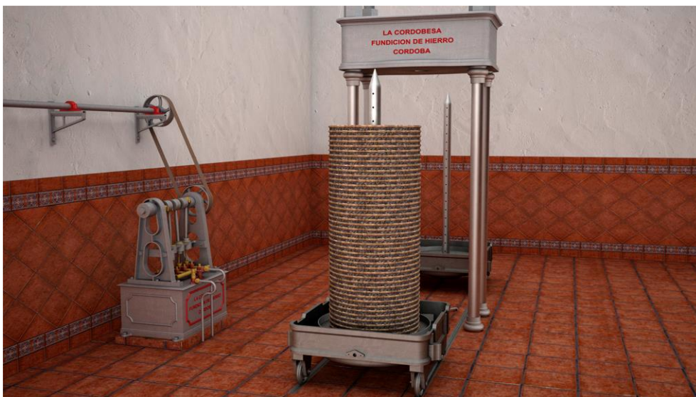
Figura 66. Escena de la recreación virtual de una prensa hidráulica de aceite de oliva.
