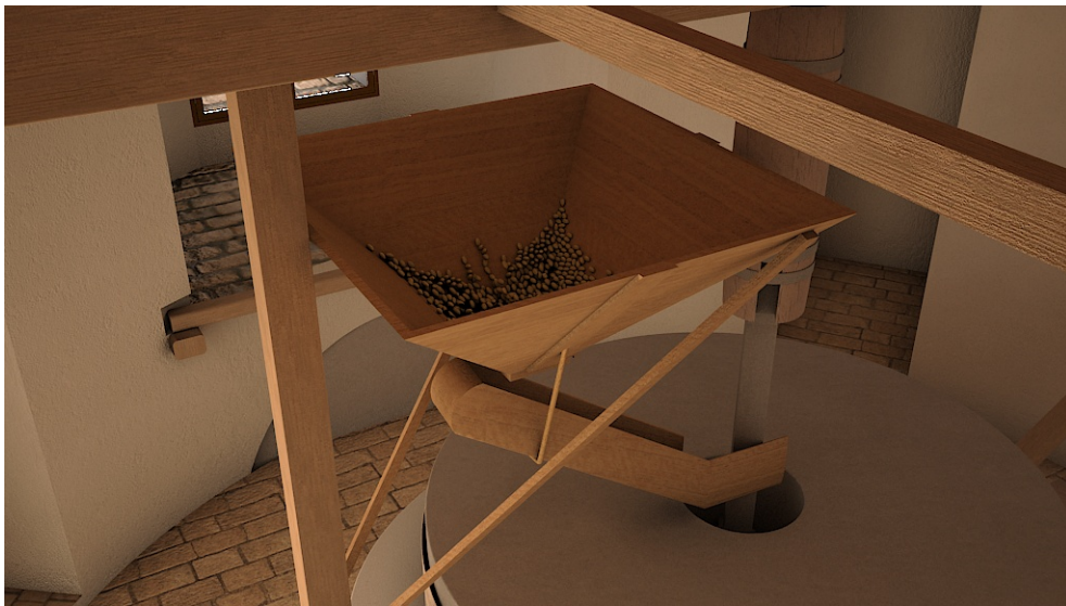
Figura 73. Escena de la recreación virtual de la tolva de alimentación de grano.
