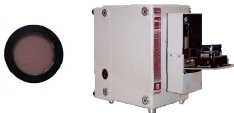
Figura 4.1. Equipo Foss NIRSystems 6500 y cápsula giratoria utilizada para el análisis de carne picada.
