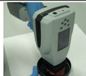
Figura 4.2. Equipo Phazir™ analizando carne picada.
