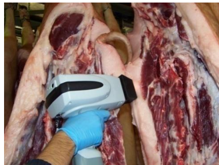
Figura 4.5. Equipo Phazir TM 1640 analizando canales de cerdo ibérico en la línea de faenado.
