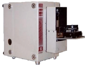
Figura 4.3. Equipo Foss NIRSystems 6500 y cápsula giratoria de transflectancia para el análisis de grasa fundida.
