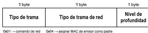
**Figura 63: Trama de red – Asignación de nodo de nivel superior y nivel de profundidad**
