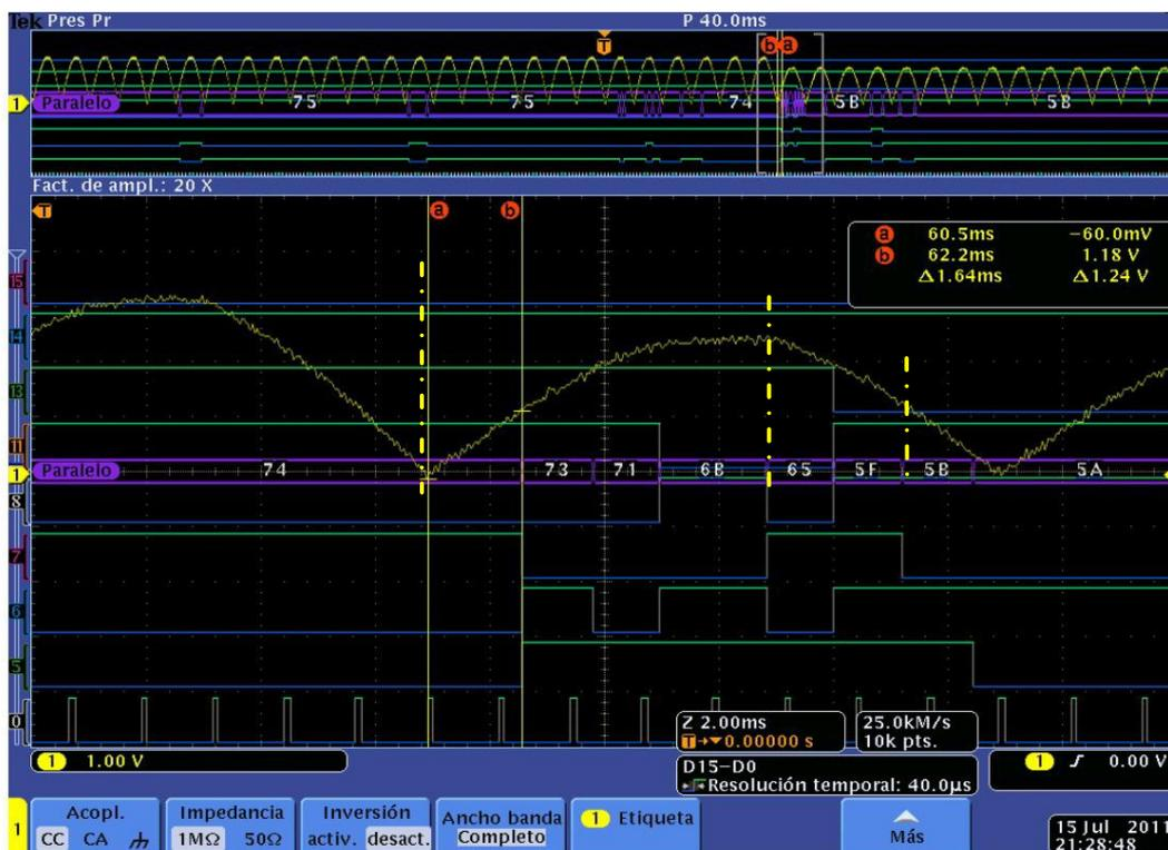
**Figura 181: Respuesta dinámica en la detección de una tensión de 0,9 p.u.**
