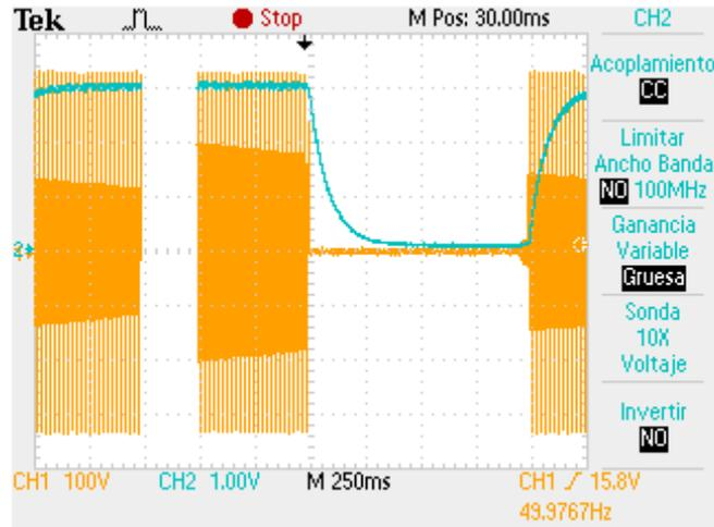
Figura 92: Respuesta del convertor RMS a CC a una interrupción de la tensión a medir de 1 s
