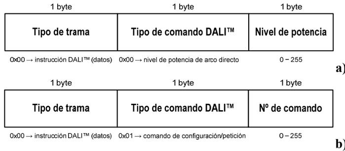
**Figura 58: Estructura de la trama de instrucción DALI™ de (a) nivel de potencia de arco y (b) comando de configuración o petición**
