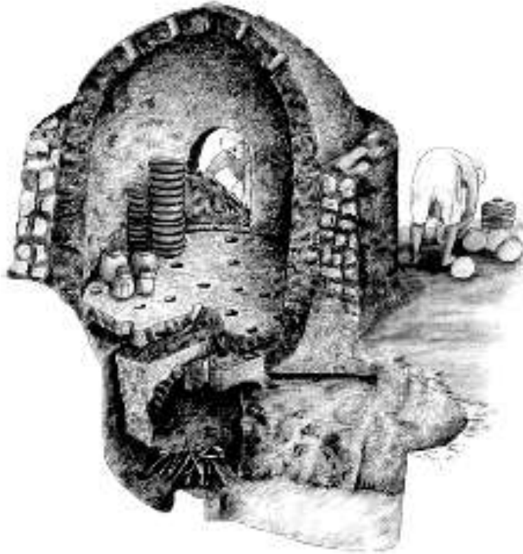
7.7.2. Restitución del horno islámico de Denia con parrilla y planta circular (THIRIOT, 1995, 18).
