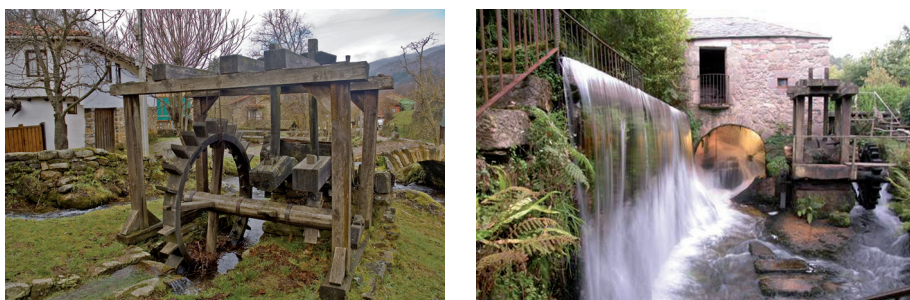
Fig. 4. Batanes como éstos de Aniezo, en Cantabria (fot. jroblear), y de Alfoz, en Lugo (fot. Finca Galea), se conservan con la misma fisonomía y componentes a los que se documentan para época bajomedieval en la cuenca del Guadalquivir.
