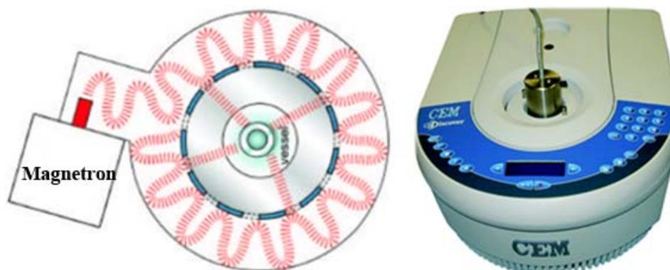
Figura III.9. Equipos de microondas focalizado.
