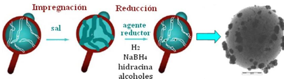
**Figura I.13. Representación esquemática de la preparación de nanopartículas soportadas por el método de deposición/reducción convencional.**
