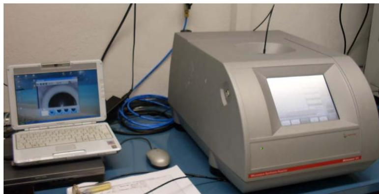
**Figura 2. Imagen fotográfica del equipo MONOWAVE-300 de Anton Paar.**
