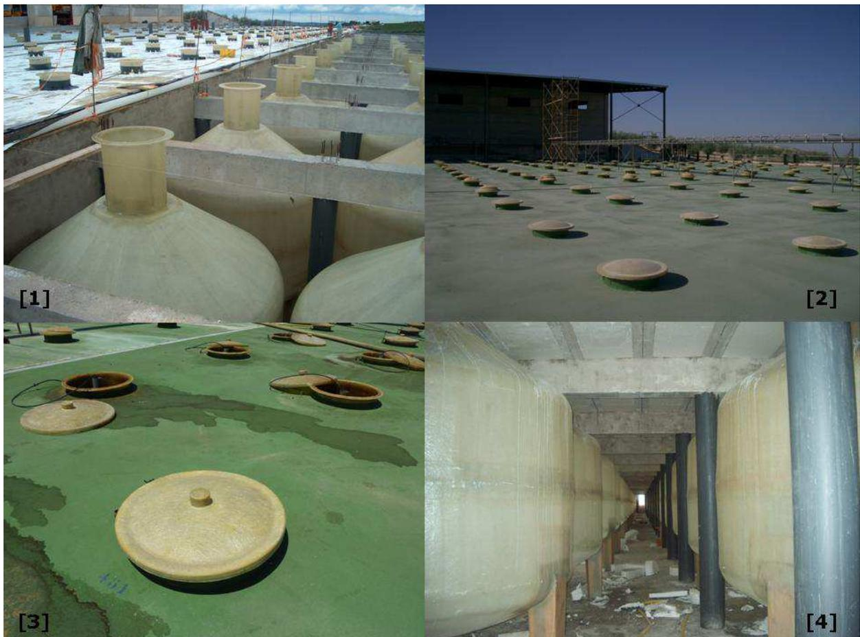
**Figura 1.5. Bodega de fermentadores, [1] fermentadores, [2, 3] boca de fermentadores a nivel del patio de la industria, [4] interior de la bodega, bajo el patio.**
