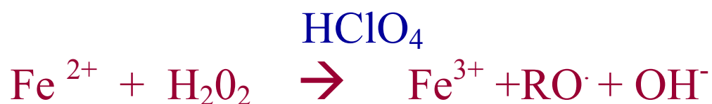
Figura 18. Reacción utilizada para la determinación de H 2 O 2 utilizando como medio ácido el ácido perclórico. Esta reacción origina iones férricos que reaccionan con el indicador anaranjado de xilenol y forman un complejo que vira a color azul y absorbe a 560nm
