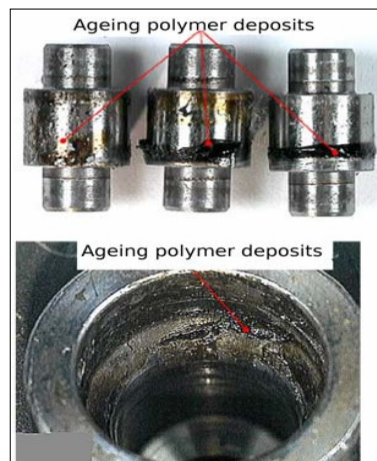
Figura 1.2. Deposición de restos carbonosos en diversas partes de un motor diesel ocasionados por el uso de biodiesel con un alto contenido en glicerina.
