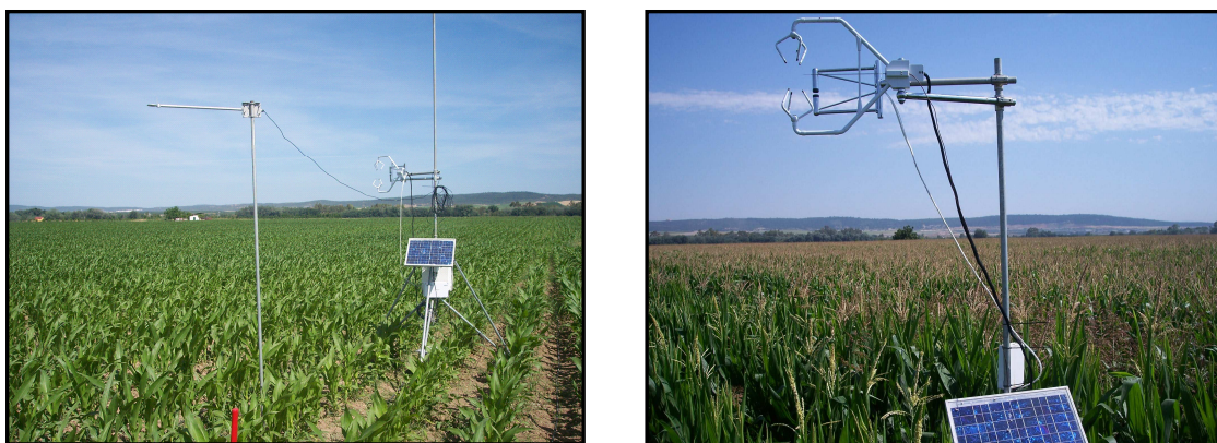
Figura II.6. Equipo de medida de evapotranspiración instalado en las parcelas de maíz (2008 y 2009).
