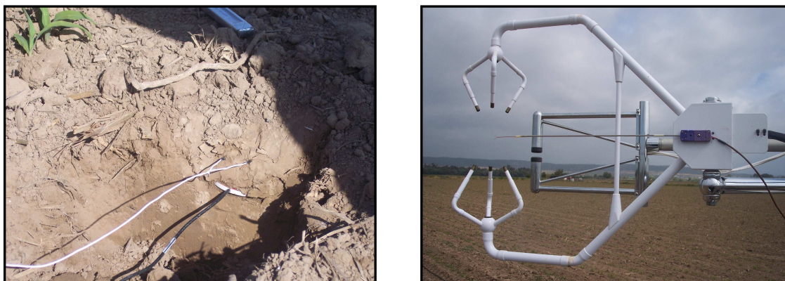
Figura II.7. Plato de flujo y termopares de suelo (izquierda) y anemómetro e higrómetro (derecha) instalados en las parcelas de maíz en el T. M. de Hornachuelos.
