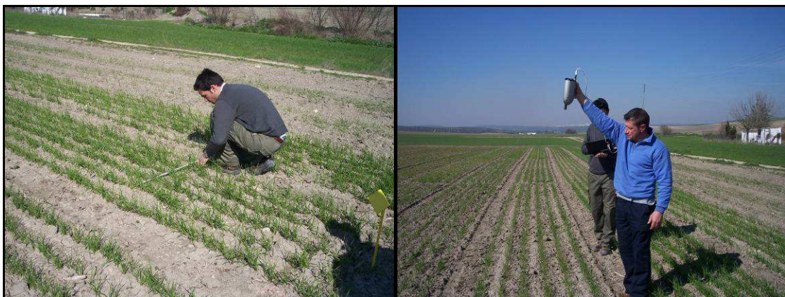
Figura I.4. Ejemplos de las medidas realizadas sobre trigo de PAR (a) y de reflectividad (b).
