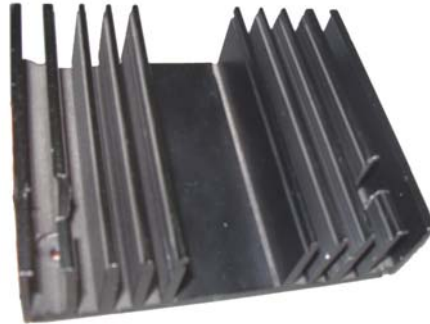
Figura 108. Fotografía del disipador de calor de aluminio sometido a ensayo.
